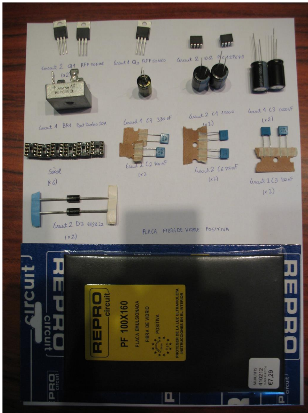
Components elèctrics utilitzats
