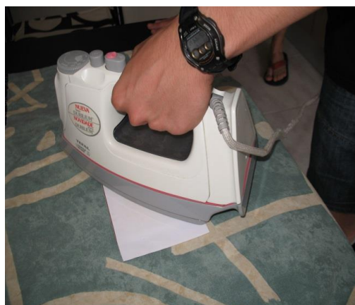
Planxant les pistes sobre la placa de coure
