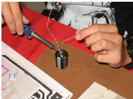
Soldant els cables als components
