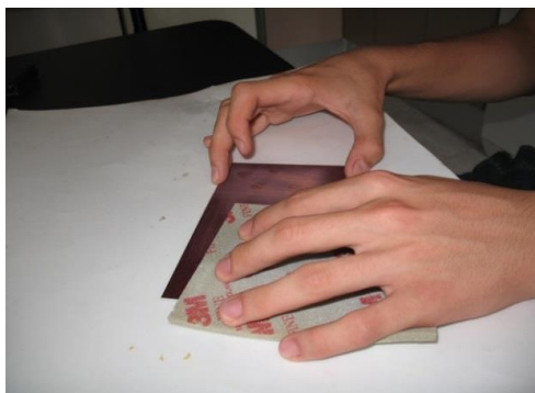
Traient el recobriments amb el paper de vidre
