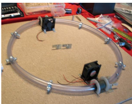
Mànega subjectada per les 6 abraçadores i amb els ventiladors
