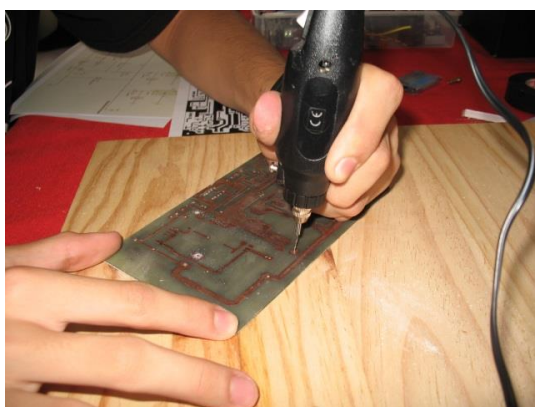
Foradant la placa amb el trepant petit
