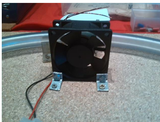
Ventilador subjectat amb els angles metàl·lics
