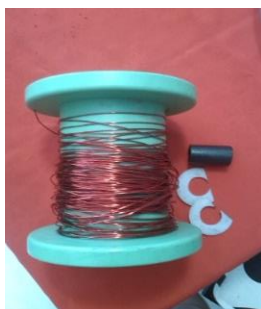
Fil de coure, nucli de la bobina i límits ja tallats
