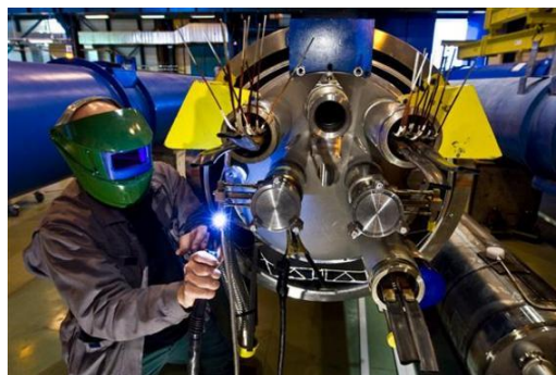
Últimes preparacions per implantar un dels imants substituïts
